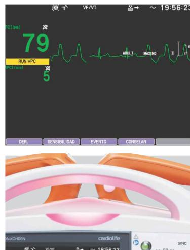
La detección de arritmia es señalada mediante el indicador de alarma, por medio de una alarma sonora y mensaje de alarma en pantalla.
